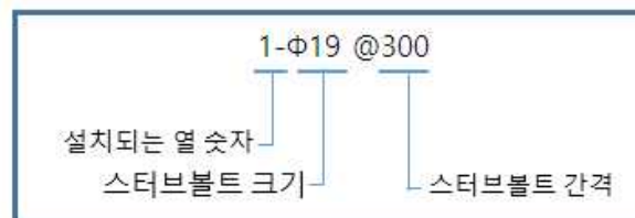
그림 66. STEEL-보의 스테드볼트의 부호 구성
