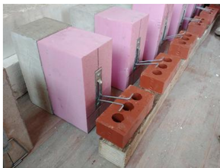
[그림 3-13] C형 연결철물부 시험체 제작
