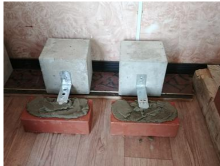
[그림 3-12] L형 연결철물부 시험체 제작
