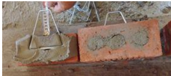
[그림 3-8] 연결철물-모르타르 부착실험 실험체 제작
