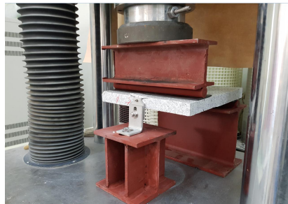
[그림 4-7] 석재패널-꽃음축 접합부 시험
